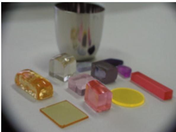
図1 田部研のガラス結晶群：ピンクが光増幅用エルビウムで、紫が赤外レーザー用のネオジウム。背景は白金ルツボ
