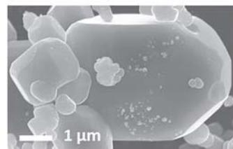
二酸化炭素還元反応用の光触媒
