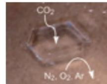
有機化合物の結晶が示す分子認識現象について研究を行っています。具体的には、温室効果気体として知られる二酸化炭素を選択的に捉えるような新しい有機化合物を合成し、その結晶の各種気体分子に対する親和性を実験的に評価するとともに、その親和性の発現メカニズムを研究しています。オープンキャンパスでは、二酸化炭素を認識する有機結晶の開発過程を紹介するので、私達の実験室で「有機化学」の面白さに触れてみませんか。
