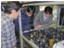
秒速数百mで飛びまわる原子をレーザー光で減速(冷却)、さらに捕獲(トラップ)します。最終的には絶対零度近くまで冷却された原子集団を、レーザー光で自在に操作し、物性物理学の基礎的な実験に役立てています。こうした原子気体は「宇宙で最も冷たい物質」と言われており、それが宇宙の片隅のちっぽけな実験室のテーブル上にある装置で生成できるので、その生成方法や冷却原子気体を用いた研究例を紹介したいと思っています。
